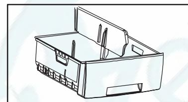
Ящик для хранения овощей оснащен двумя передвижными перегородками, которые можно устанавливать в одно из пяти положений для разделения разных овощей и фруктов.
