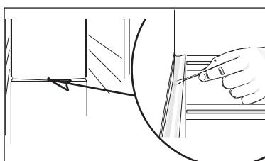
У некоторых моделей сзади имеется звукоглушица из пластины. Она крепится четырьмя винтами и должна сниматься во время чистки. Прикрепив пластину на место, убедитесь, что она установлена в том же положении.
